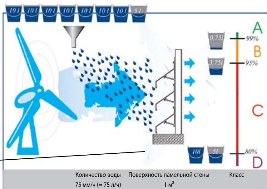
Испытание стандартной фасадной системы Линиус® с сеткой и водоотливом
