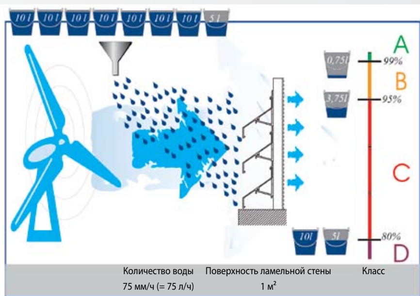
Испытание стандартной фасадной системы Линиус®
